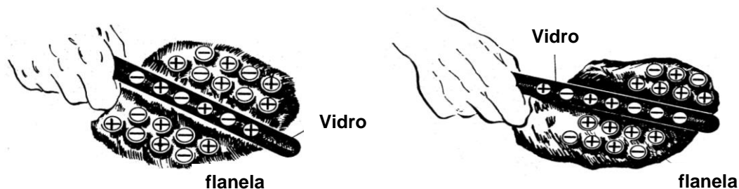
Fig. 7: O bastão de vidro e a flanela antes de se atritarem estão inicialmente neutros. Atritando-se os dois, verifica-se o fenômeno de alguns átomos da flanela cederem elétrons aos átomos do bastão de vidro, ficando o bastão eletrizado negativamente e a flanela tendo perdido elétrons, carregada positivamente.
