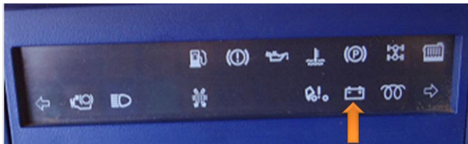
Falta de carga na bateria
